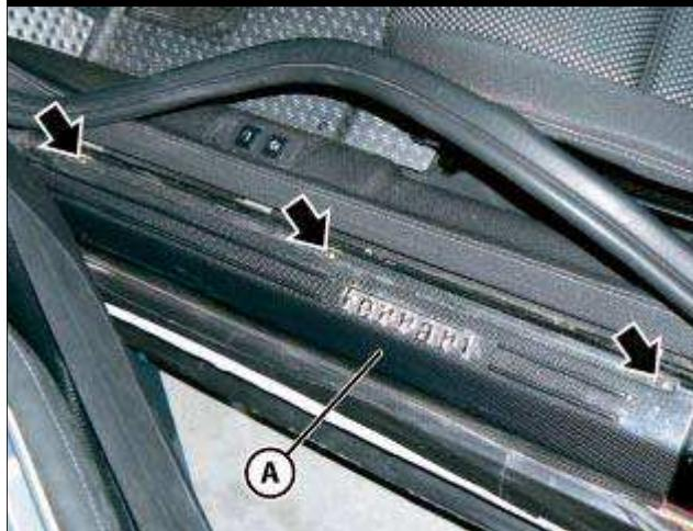
● 紧固门槛密封条 (A)，拧紧三个指示的螺钉。
