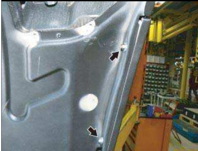
● 在后部翼子板内, 松开指示的两个上部紧固螺母。
