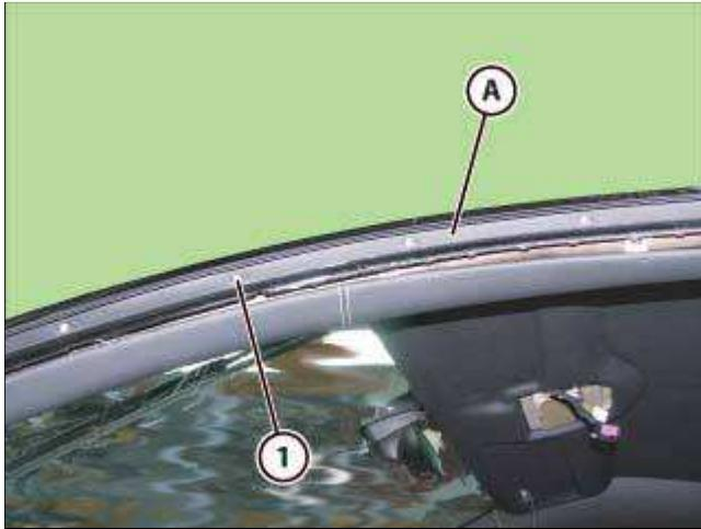
● 对齐后端与拆卸过程中作出的标记，固定上部车门框镶边饰条(A)，并紧固8个螺钉(1)。
