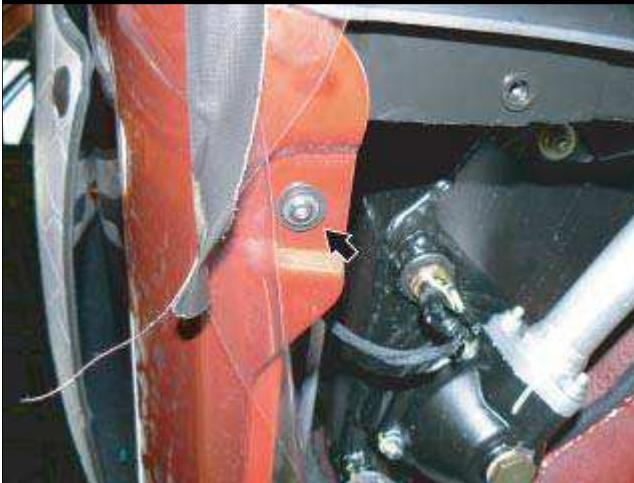
● 在车辆前部，拧紧指示的下方紧固螺钉。
