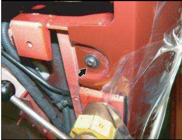
● 在车辆后部, 松开指示的下方紧固螺钉。
