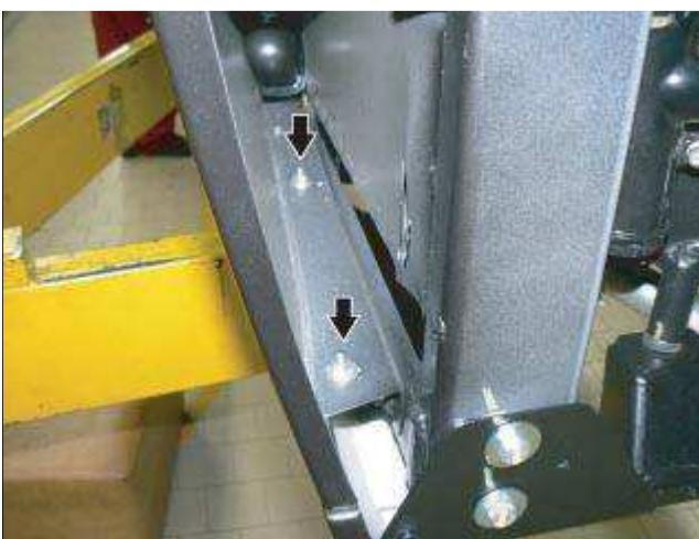
● 在前部挡泥板内，拧紧指示的两个上部紧固螺母。
