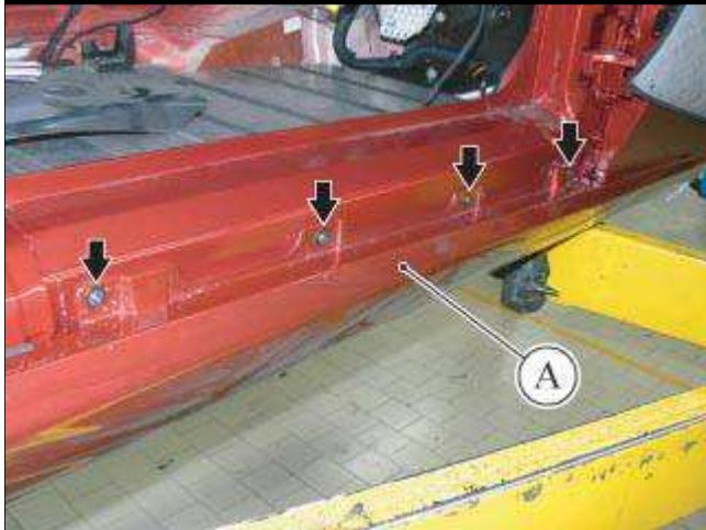
● 在车辆中部, 松开指示的四个中央紧固螺钉。
