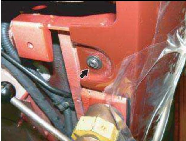
● 在车辆后部，拧紧指示的下方紧固螺钉。
