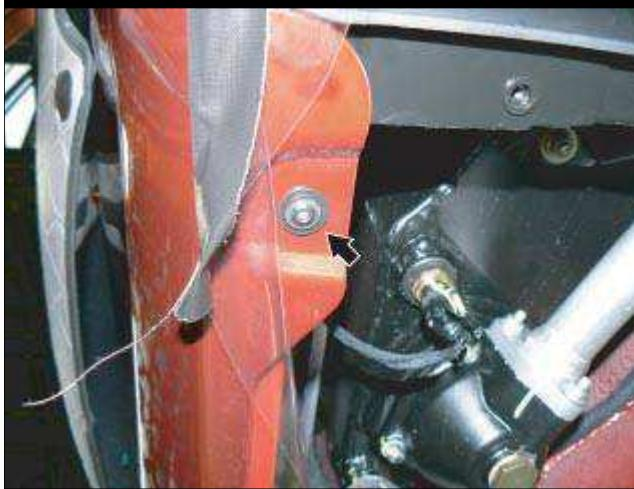
● 在车辆前部, 松开指示的下方紧固螺钉。
