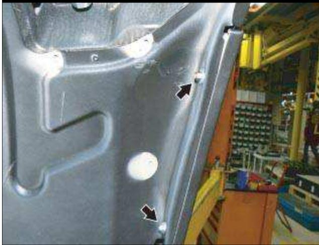
● 在后部挡泥板内，拧紧指示的两个上部紧固螺母。
