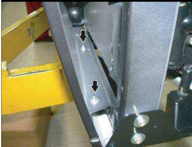
● 在前部翼子板内, 松开指示的两个上部紧固螺母。
