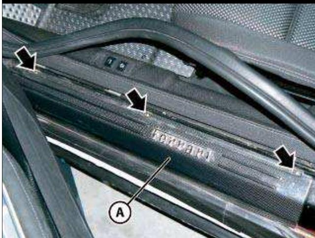
● 松开紧固门槛密封条 (A) 的三个指示螺钉。
